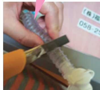
① Bさんに合った長さを測り、カッターで切り目をつけます。
