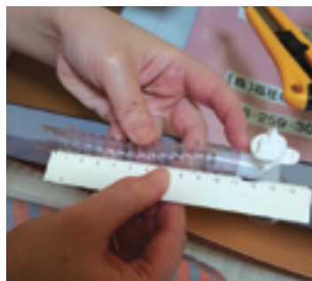
① Bさんに合った長さを測り、カッターで切り目をつけます。
